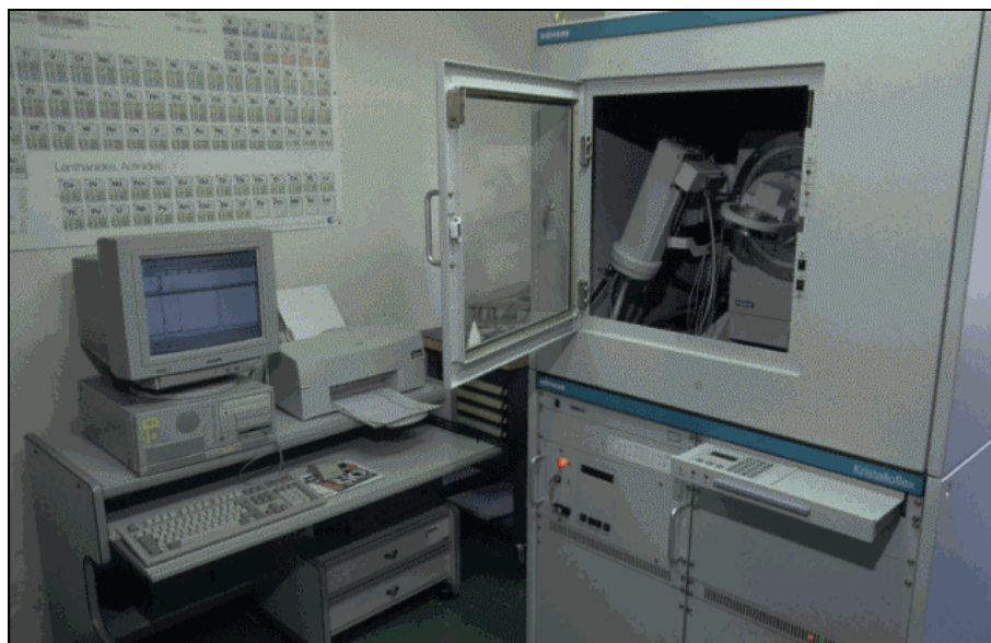
Figura 4.13 Difractómetro empleado para la determinación de las tensiones residuales.
