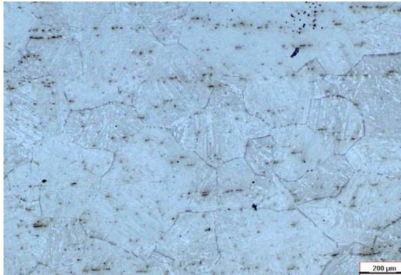
Figura 5. 12 Metalografía de la probeta recalentada a 1330^{\circ}\text{C} con los límites decorados con ferrita para poder medir el tamaño de grano
