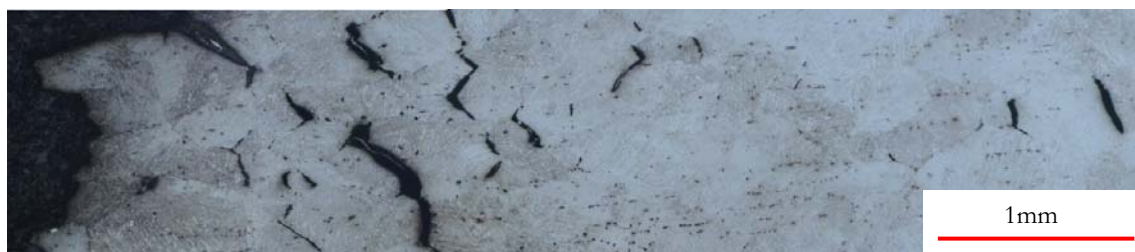
Figura 5. 20 Metalografía de la probeta de acero A2 ensayada a 800 tras un recalentamiento a 1330°C
