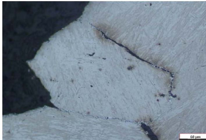
Figura 5. 22 Metalografía de la probeta de acero A2 ensayada a 700°C tras un recalentamiento a 1330°C
