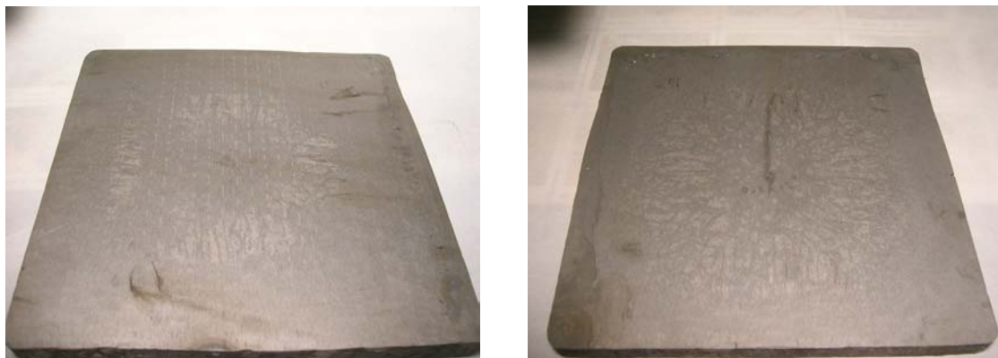
Figura 8. 2 Secciones transversales de las palanquillas de a) acero A1 y b) acero B tras un macroataque con HCl 37% durante 30'
