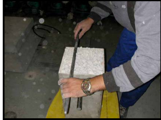
Figura 5.23.- Enrasado del árido dentro del cubilote metálico
