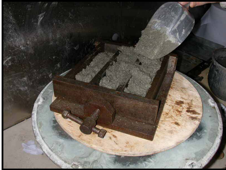
Figura 5.62.- Llenado de las probetas prismáticas de mortero
