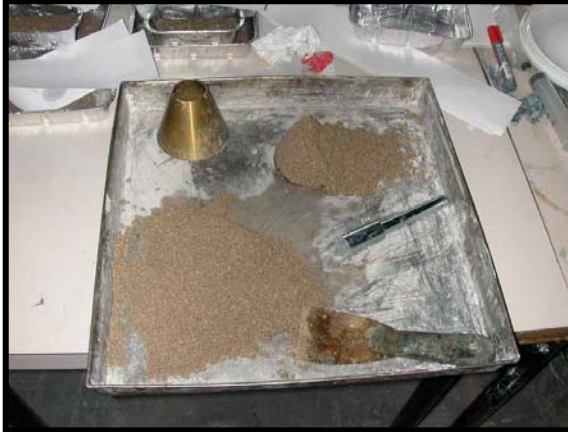
Figura 5.8.- Instrumentos utilizados para la obtención del coeficiente de saturación de la arena
