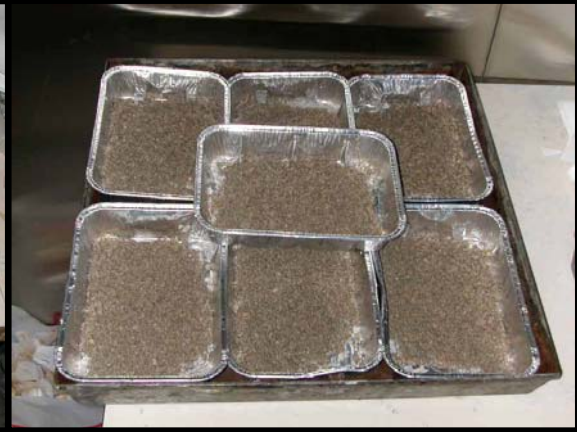
Figura 5.9.- Muestras de arena después de haber sido centrifugadas y pesadas
