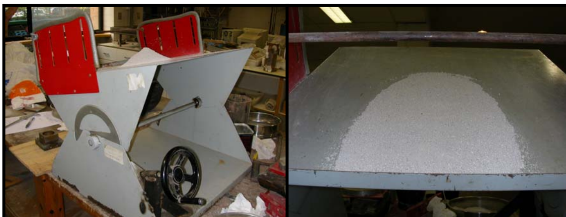
(a) (b) Figura 5.58.- Proceso de inclinación de superficie
