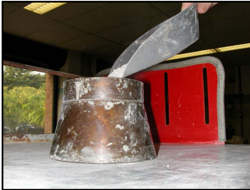
Figura 5.56.- Detalle del Inclínómetro y llenado del molde
