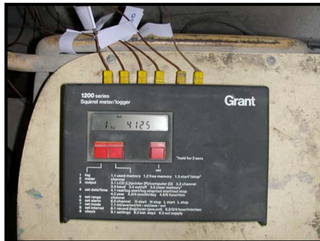
Figura 5.37.- Aparato para la adquisición de datos térmicos "squirrel"
