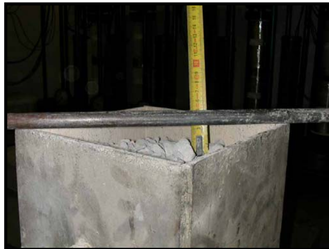
Figura 5.24.- Medida del asentamiento del árido respecto al borde superior
