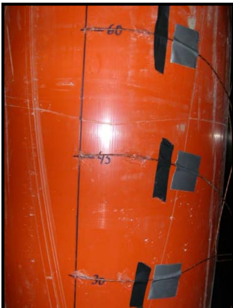
Figura 5.36.- Perforaciones longitudinales en el recipiente
