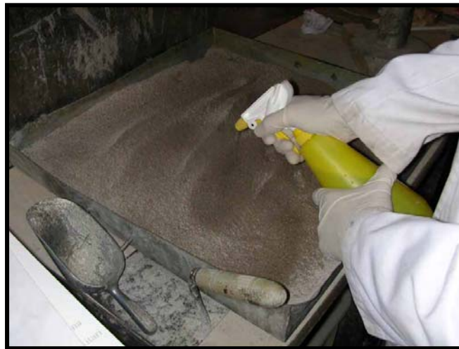
Figura 5.51.- Método de humidificación de los áridos
