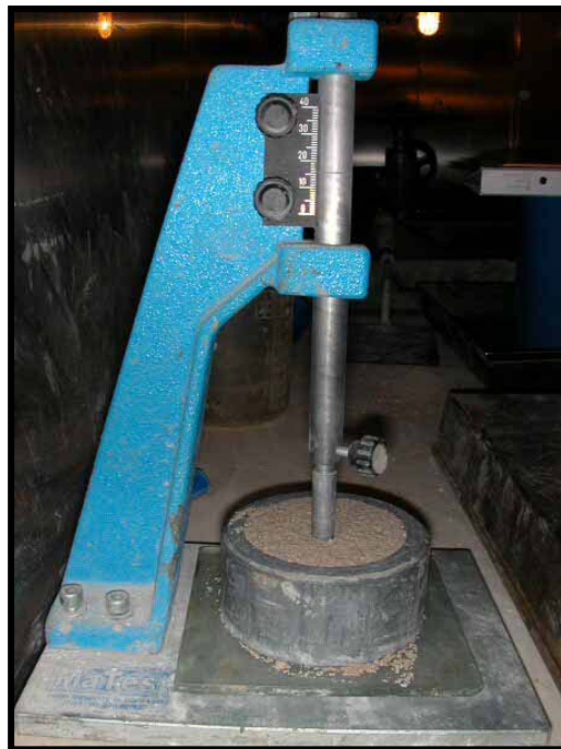
Figura 5.53.- Ensayo de penetración de la sonda de Vicat en la arena
