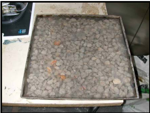
Figura 5.6.- Bandeja con árido grueso en saturación (sumergido)
