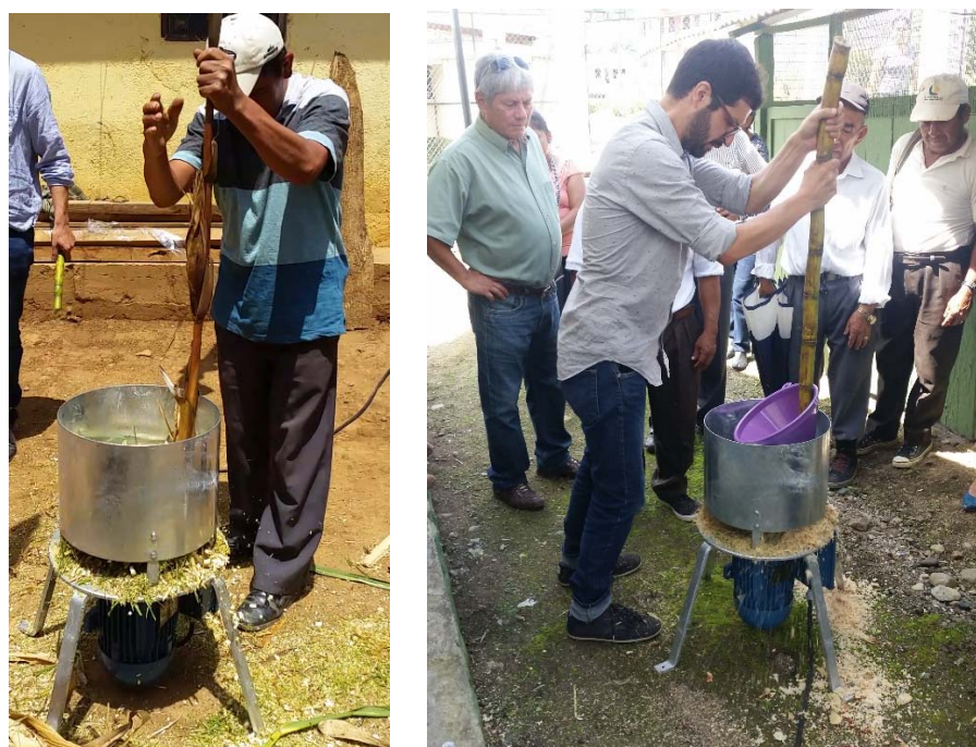
Imagen 5.2. Funcionamiento de la trituradora con caña de maíz (a) y caña de azúcar (b) Cariamanga (a) Quilanga (b), Ecuador; septiembre 2017.
