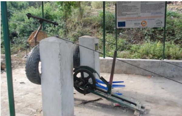
Figura 3.4. Estación inferior de un teleférico Fuente: CDEI-UPC - Practical Action Nepal
