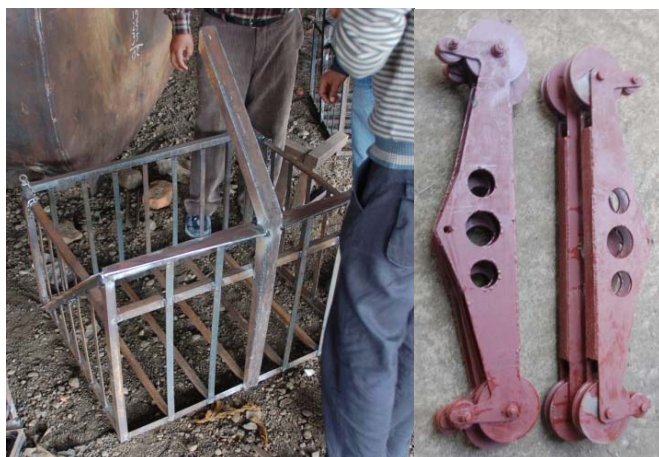
Figura 3.2. Cesta y carro de unión al cable tractor
