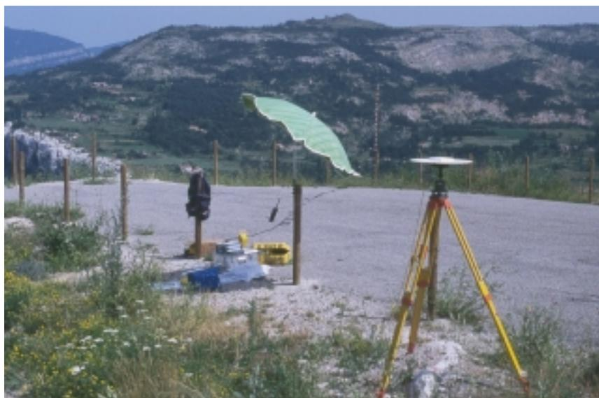
Foto 4.5: Dispositivo de control de desplazamientos con GPS.
