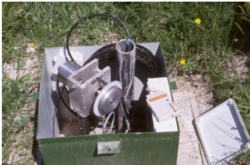
Foto 4.3: Piezómetro instalado en un sondeo del deslizamiento de Vallcebre.
