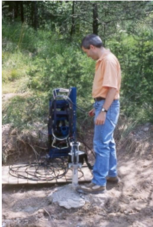
Foto 4.2: Inclinómetro de un sondeo del deslizamiento de Vallcebre.
