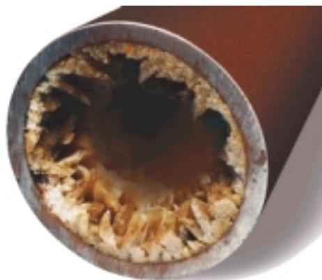
Figura 4.19. Deposición de mineral (carbonato de calcio) en las tuberías del sistema de extracción de petróleo (Crabtree *et al.*, 1999).
