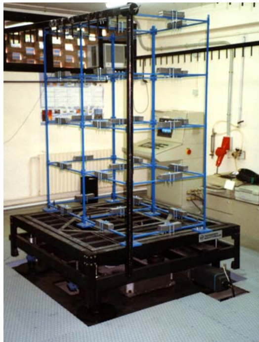
Figura 3.3 Fotografía del modelo utilizado en el laboratorio y de la mesa vibradora.
