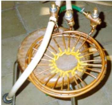
Foto 22: Conexiones hidráulicas y eléctricas coincidentes.
