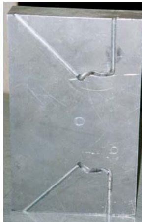
Foto 14: negativo de las espiras de cada semiestator sobre aluminio. El mecanizado se realizó en el Centre CIM de la UPC.
