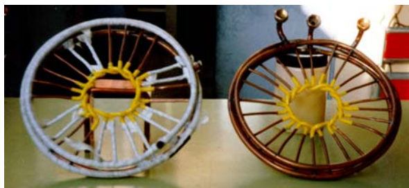
Foto 20: Semiestatores en los que se pueden observar los aislantes entre espiras, los refuerzos para equilibrar la tensión mecánica, y la entrada eléctrica e hidráulica apiñada en una zona concreta.
