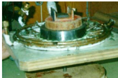
Foto 24: Proceso de prensado. Se utilizan dos maderas y un espárrago roscado.
