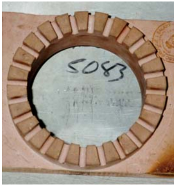
Foto 15: Molde de poliuretano para controlar la segura disposición de las espiras.
