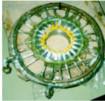
Foto 27: resultado definitivo del prensado en el semiestátor 2
