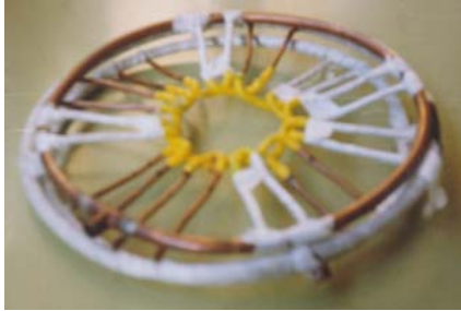
Foto 18: Semiestátor con aislantes de fibra de vidrio y silicona.
