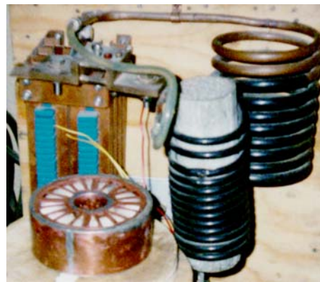
Foto 40: Vista del circuito R-L del horno de inducción capaz de suministrar 20 A a una frecuencia de 5 kHz.
