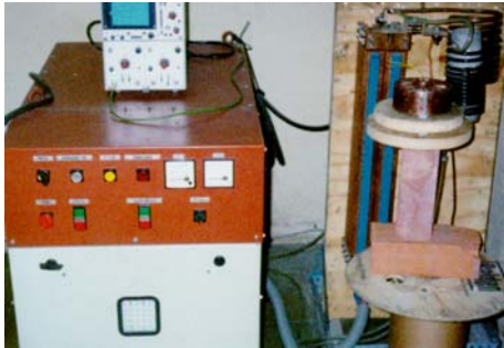
Foto 39: horno de inducción y P-3 a punto para hacer un ensayo.
