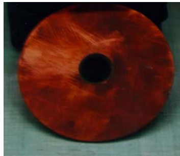
Foto 47: Rotor conductor de cobre utilizado en el P-7
