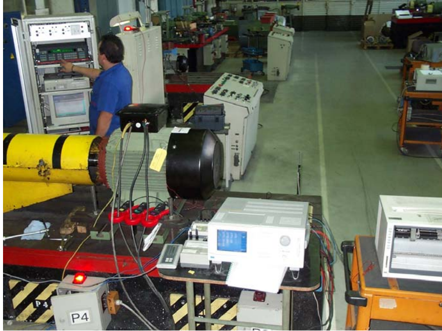
Figura 7.28.- Ensayo en laboratorio AEG motor tamaño IEC 225 4 polos.
