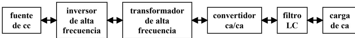
Figura 2.1. Diagrama de bloques de los inversores con aislamiento en alta frecuencia tipo directo.
