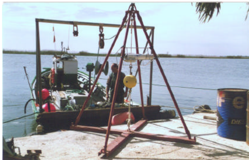
Figura 4.14.- Tetrápodo con el sistema PUV para medidas hidrodinámicas fuera de la zona de rompientes durante la campaña Delta'96.
