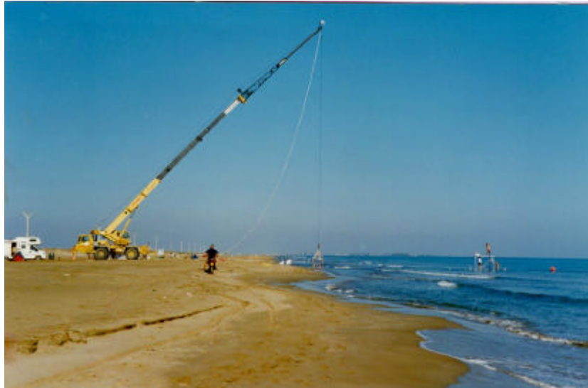
Figura 4.12.- Grúa utilizada para las filmaciones de la zona de rompientes. Delta'96.
