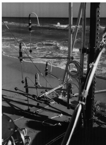
Figura 4.7.- Disposición Helicoidal de los correntímetros electromagnéticos en el trineo
