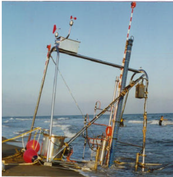
Figura 4.6.- Trineo con sensor de alturas de olas, 6 correntímetros electromagnéticos, 2 sensores de sedimento en suspensión, compás y estación meteorológica usado en Delta'96.
