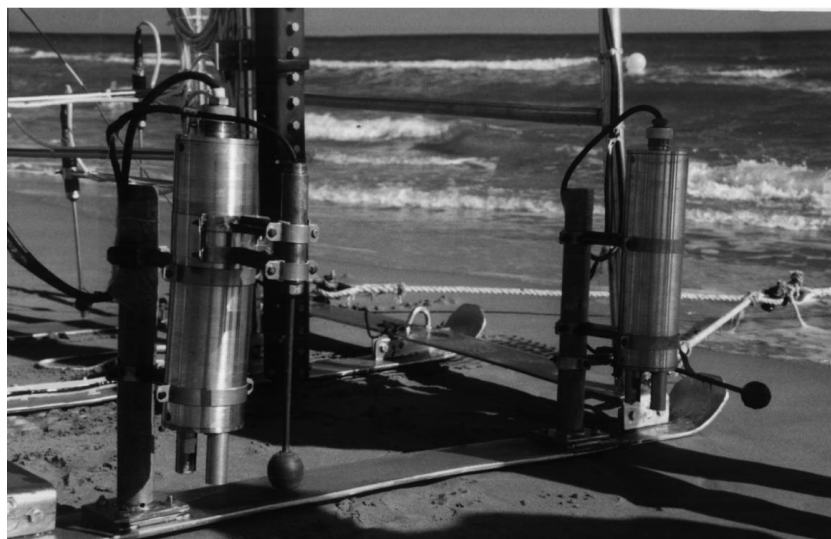
Figura 4.10.- Turbidímetros acoplados a los correntímetros electromagnéticos cerca del fondo.
