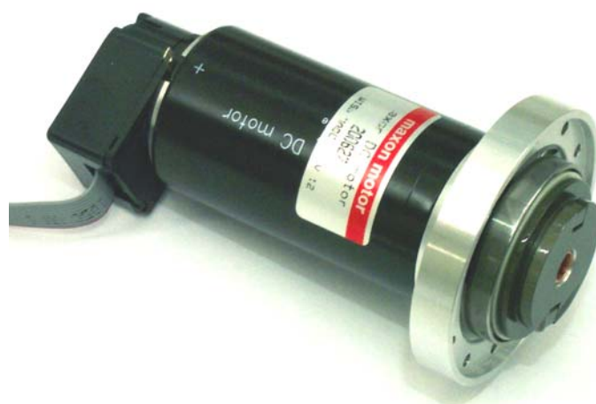
Fig. 5.13. Wave generator acoblat directament al rotor del motor i tapa del bloc del reductor per fixar-hi el motor en la 2a sèrie d'experiments
