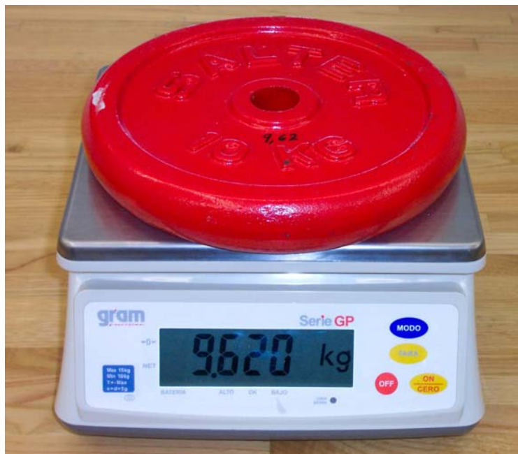
Fig. 5.25. Bàscula digital GRAM PRECISION ADW-15KC
