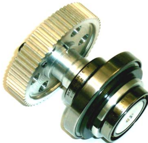
Fig. 5.8. Wave generator amb els rodaments que suporten l'arbre d'entrada i la politja
