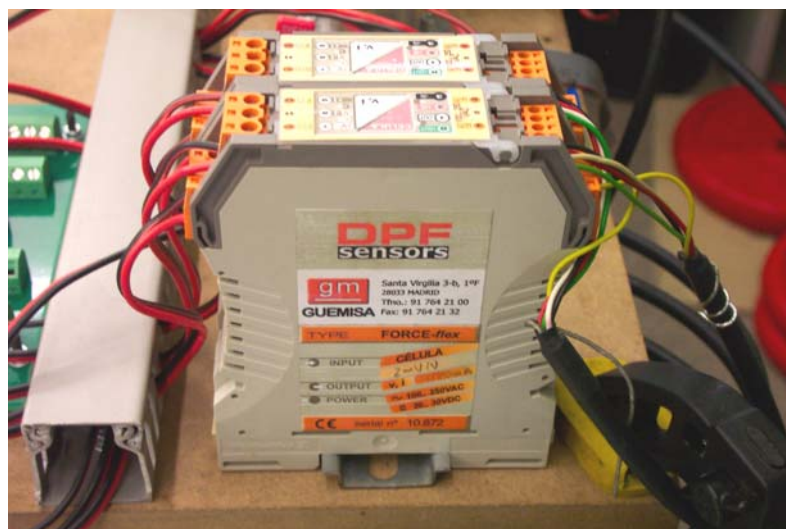
Fig. 5.24. Muntatge dels dos amplificadors per a les cèl·lules de càrrega
