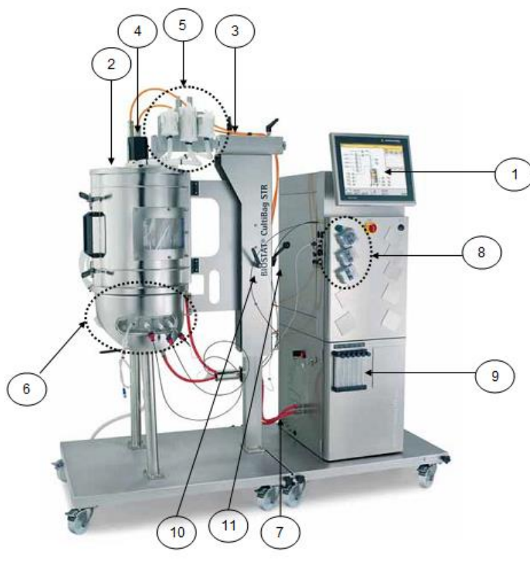
Figura 9.3: Partes del biorreactor STR50 SU: 1. Pantalla de la unidad digital de control (DCU), 2.Soporte para bolsa de cultivo ( Bag Holder ), 3.Brazo del motor, 4.Motor del agitador,5.Soporte para filtros, 6.Camisa de calefacción 7.Tubos de entrada/salida de agua a la camisa de calefacción, 8.Bombas de la DCU, 9.Rotámetros para caudal de gases, 10. Manivela para fijar la posición del soporte, 11. Brazo para ajustar la posición del soporte
