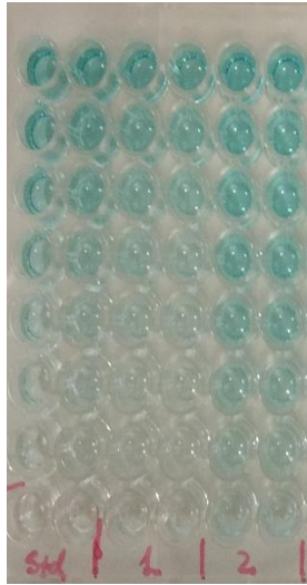
Figura 3.5. Placa ELISA positiva para diversas muestras de IFN \gamma
