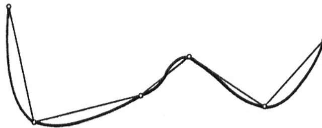
POLIGONAL Y CURVA DE BEZIER FIGURA 2-3-2-5-A
