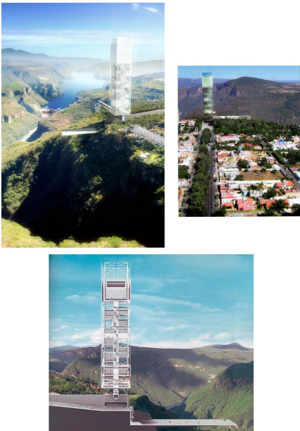
Fig. 29. La expresión de las relaciones contextuales: fotomontajes panorámicos que muestran el ensamblaje del edificio con el entorno natural y con la construcción existente y su situación urbana en referencia al Parque Mirador Independencia; y sección fotomontada que ilustra su configuración interna y la penetración de la plaza en voladizo —de una longitud de más de 100 metros— en el espacio de la barranca. Guggenheim Guadalajara (2005) - Enrique Norten.
