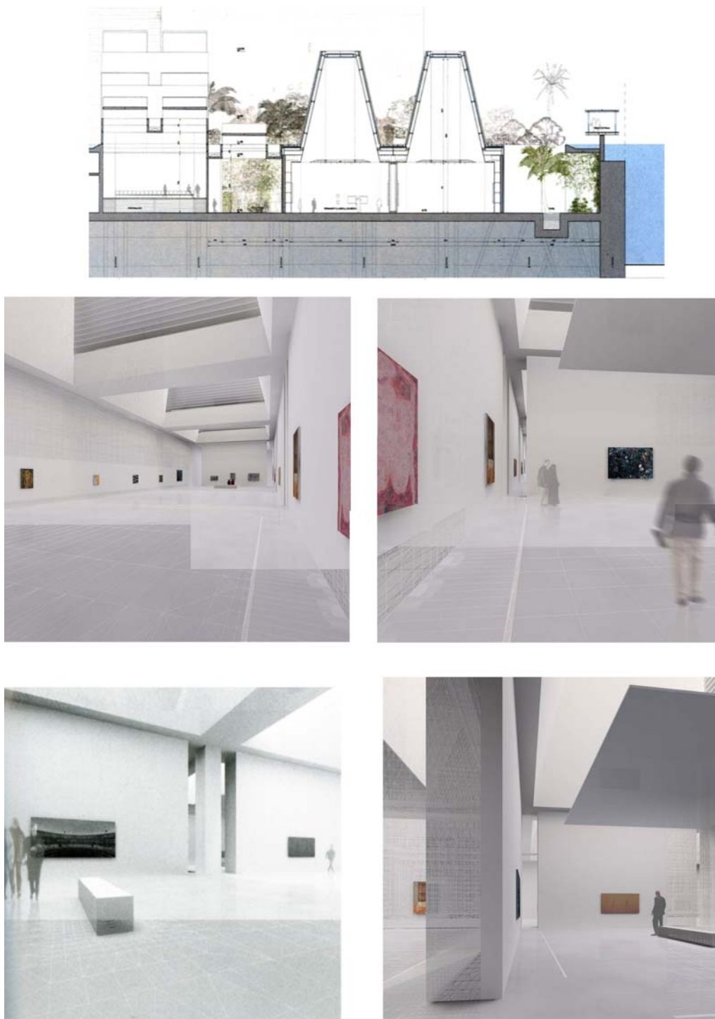
Fig. 4. La representación informática realista de los diversos espacios expositivos inundados por la iluminación natural: sección por las galerías donde se aprecia la peculiar forma de pirámide truncada de los lucernarios de la galería de arte moderno y la intercalación entre espacios expositivos y espacios abiertos; y renderings de las diferentes galerías que muestran un posible acomodo de la colección, los intersticios por donde penetra la luz y una simulación realista de los efectos de ésta. Guggenheim Río (2002) - Jean Nouvel.
