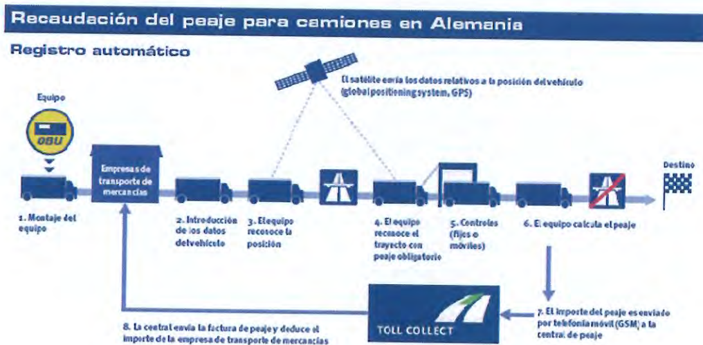
Fig. 2.13. Sistema de cobro en Alemania empleando GPS/GSM para camiones. (Fuente: Toll Collect. Alemania 2005).
