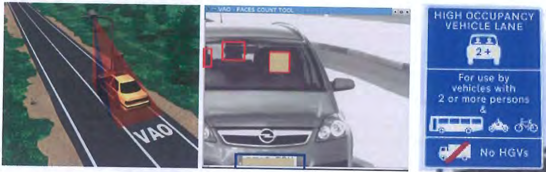
Fig. 2.3. Detección automática de la alta ocupación vehicular y señalización de los carriles VAO. (Fuente: Bautista, 2007 y WSDOT, 2003).
