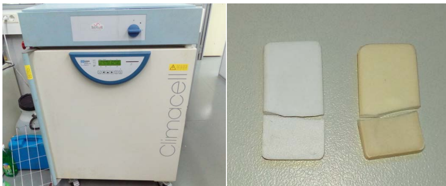
Figura 2.10. Cámara empleada para ensayar las condiciones de envejecimiento acelerado (izquierda). Muestras pre- y post-envejecidas utilizadas para realizar las pruebas de impacto (derecha).
