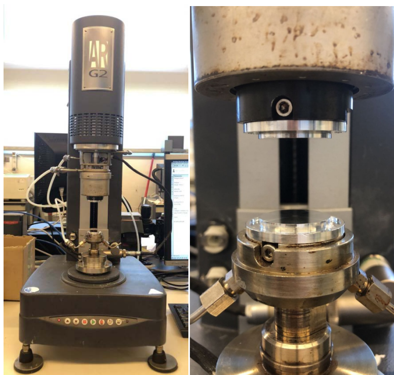
Figura 2.8. Reómetro y configuración plato-plato utilizados para la determinación de la viscosidad de los geles de curado UV.
