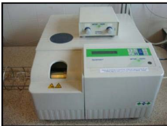
Figura 2.6. Equipo de TGA utilizado para el análisis de estabilidad térmica de todos los materiales curados.
