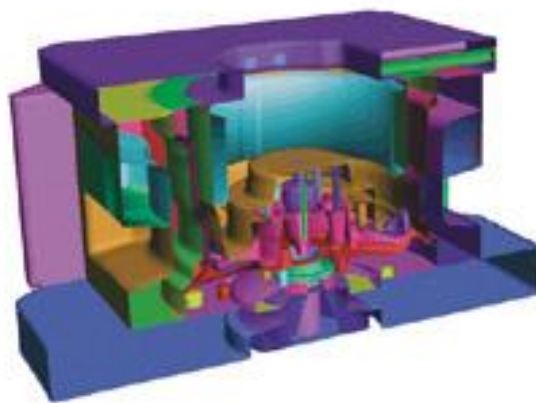
Figura 1.28. Ejemplo mallado componentes de un molde con programa QuitCAST. Fte.: (ESI Group 2017).
