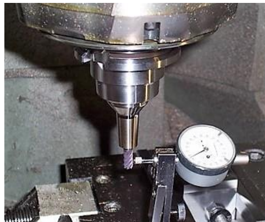
Figura 4.35. Medición de la excentricidad de la herramienta.
