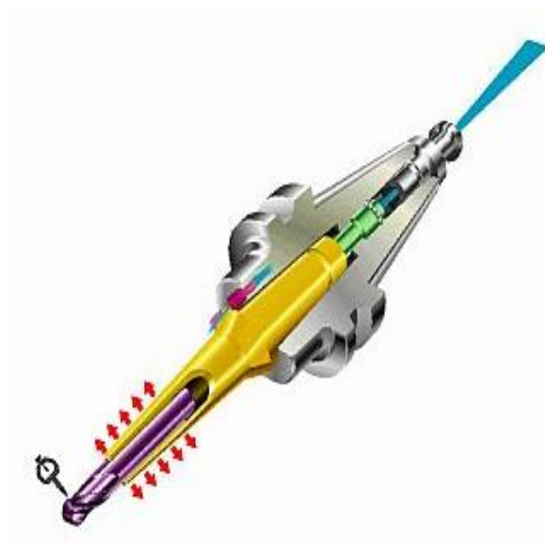
Figura 2.40. Fijación térmica de la herramienta, con cono ISO tipo BT. Fte.: (MST 2004).
