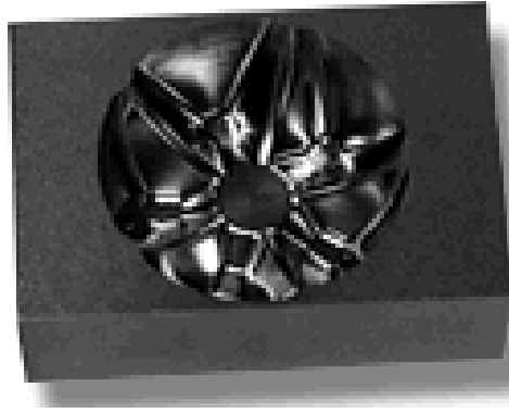
Figura 2.2. Postizo de un molde de inyección de plástico. Fte.: (Makino 2003).
