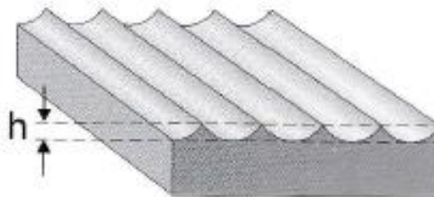
Figura 1.18. Acabado superficial teórico o altura de cresta, h . Fte.: (Hitachi 2003).
