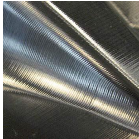
Figura 2.20. Acabado con optimización del Control. Fte.: (Heidenhain 2007).
