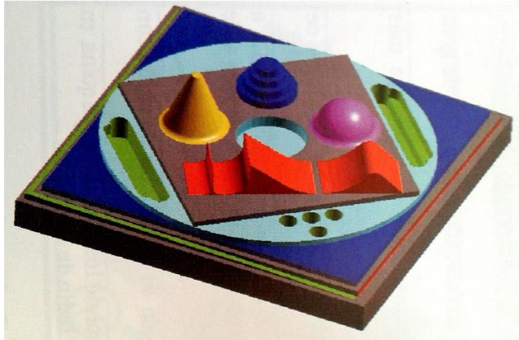
Figura 2.15. Pieza test NCG. Fte.: (López de Lacalle 1999).
