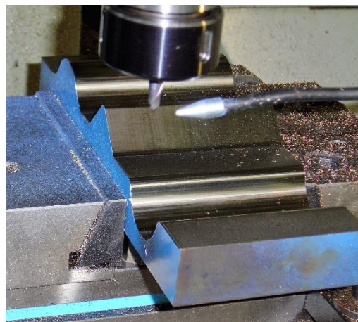
Figura 6.2. Pieza test en proceso de mecanizado, fase semiacabado.
