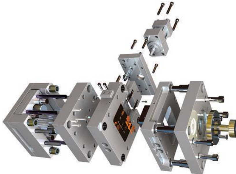
Figura 1.24. Ejemplo de molde de inyección de plásticos. Fte.: (SOLIDWORKS 2017).
