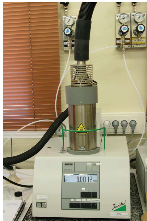
Figura 3.2. Fotografía del equipo de análisis térmico utilizado para determinar el calor de reacción.
