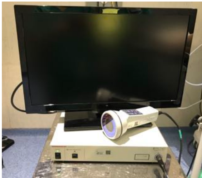
Fotografía 7: sistema PDE (Photodynamic Eye near infrared fluorescence imager C9830, Hamamatsu Photonics, Hamamatsu, Japón). Fuente: elaboración propia.
