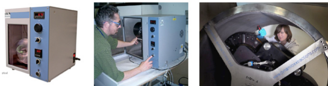
Figura 1.4 Aparells de CCC comercialitzats per Dynamic Extractions (Slough, UK). a) MiniCCC, volum intern 18 mL, processat mostres 10-300 mg; b) MidiCCC, volum intern 19-940 mL, processat mostres fins a 15-25 g amb columna gran; c) MaxiCCC, volum intern 18.000 mL, processat mostres 1.500 g.
