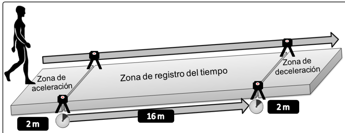
Figura II-2. Esquema de la valoración de la máxima velocidad de marcha. Registro del tiempo de la zona central de 16 metros de longitud mediante un sistema de células fotoeléctricas. Hay una zona de aceleración y otra de deceleración de dos metros de longitud cada una.
