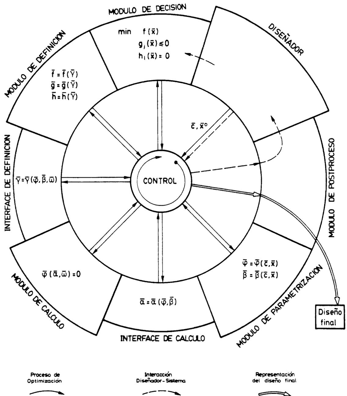
Figura 4.5.- Representación esquemática del flujo de información en un sistema modular de diseño óptimo.
