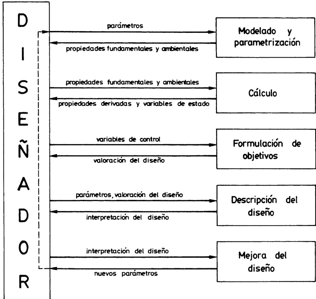
**Figura 4.3.- Estructuración operativa del proceso de diseño. Relaciones y transmisión de información entre los diversos niveles.**
