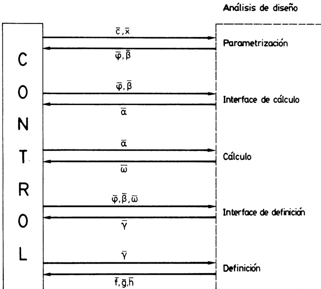
**Figura 4.6.-** Flujo de información entre los módulos de un sistema de diseño óptimo durante la obtención de los valores de la función objetivo y de las funciones que definen las restricciones.
