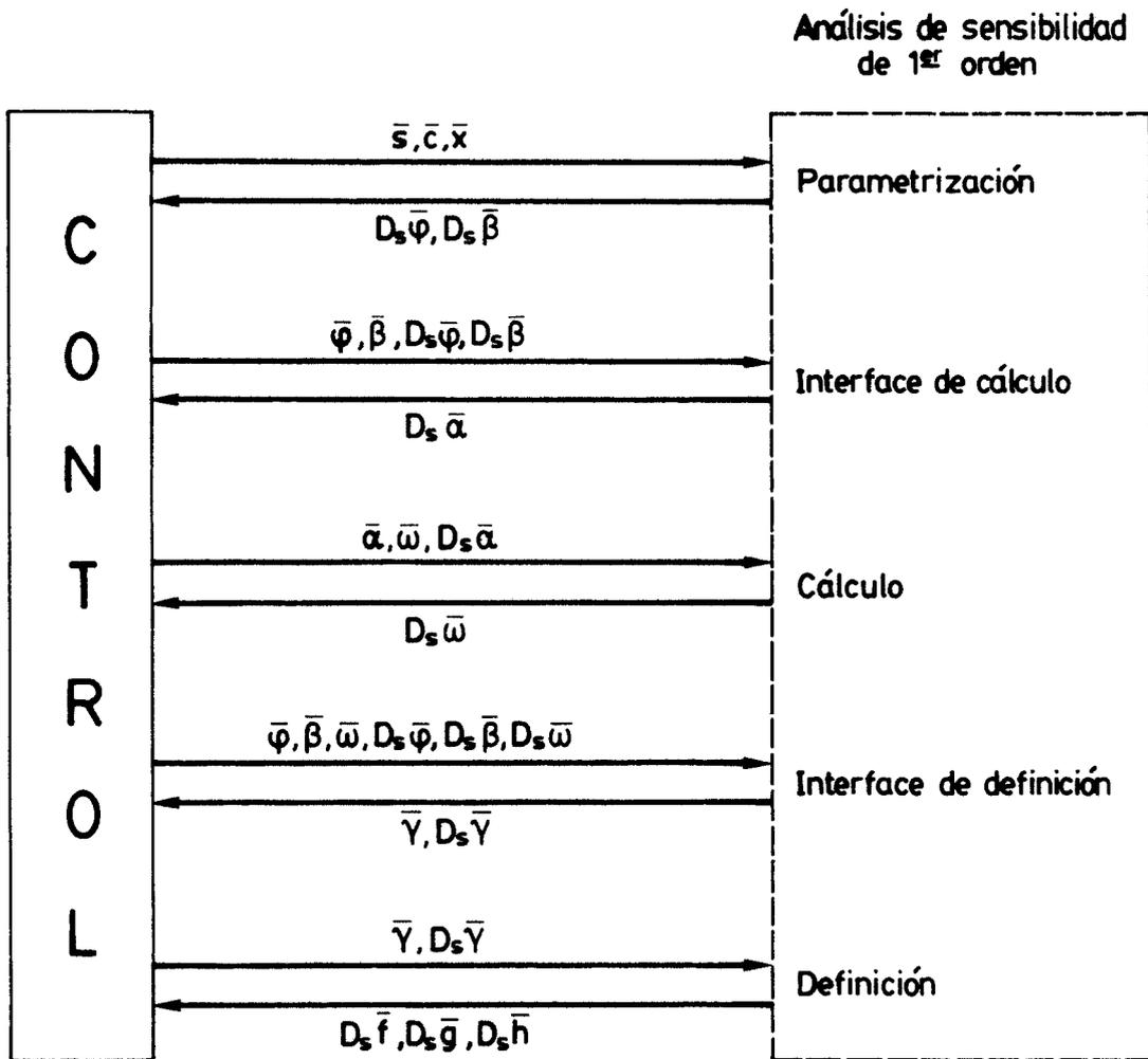
Figura 4.7.- Flujo de información entre los módulos de un sistema de diseño óptimo durante la realización del análisis de sensibilidad de primer orden para una dirección " $\bar{s}$ " de modificación del diseño. (presuponiendo que se ha realizado previamente el cálculo)
