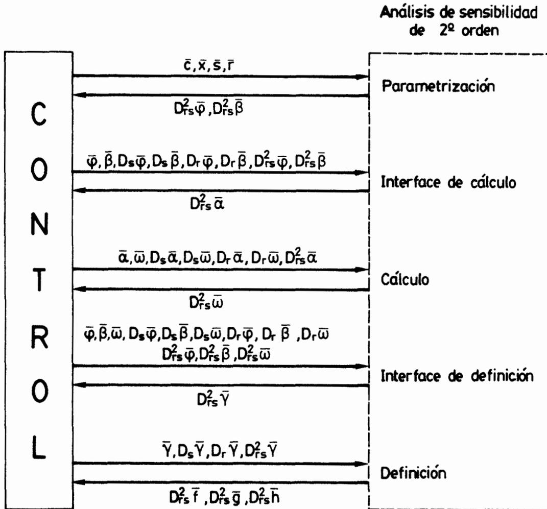
**Figura 4.8.-** Flujo de información entre los módulos de un sistema de diseño óptimo durante la realización del análisis de sensibilidad de segundo orden para dos direcciones "s", y "r" de modificación del diseño. (presuponiendo que se han realizado previamente el cálculo y los análisis de sensibilidad de primer orden para ambas direcciones)
