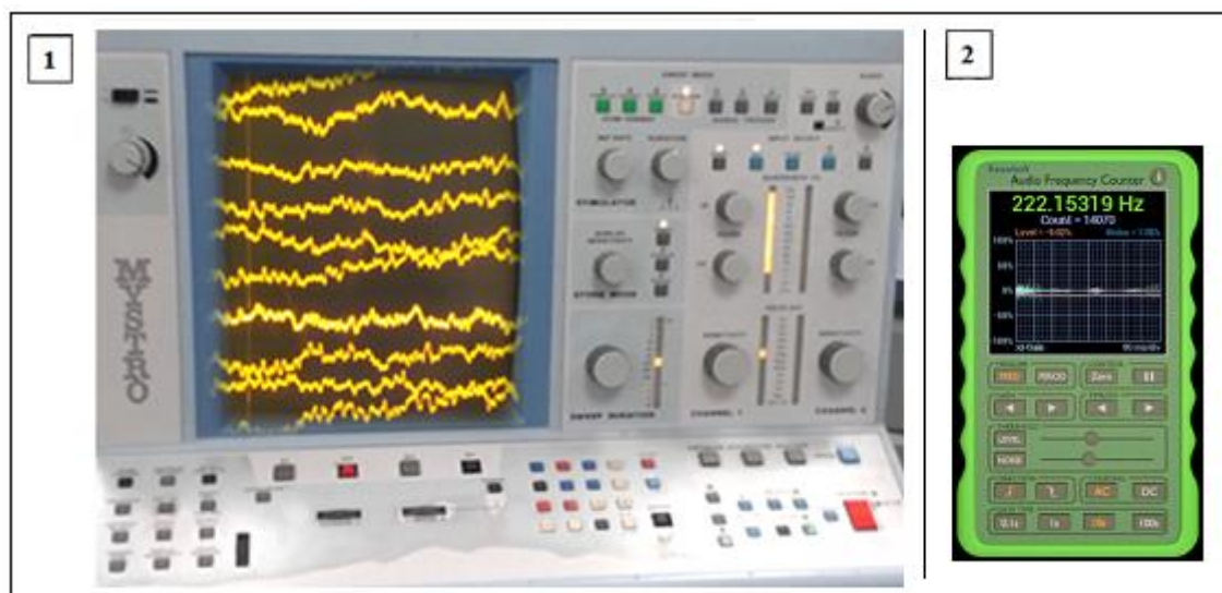
Figura M. 10. Sistema d'electromiografía. Desglose de los elementos principales. 1) Electromiógrafo convencional (Medelec Mystro plus, GR20). Se muestra un ejemplo de ruido de placa; 2) Contador de frecuencia (Audio Frequency Counter). Fuente: Archivo de imágenes de la Unidad de Histología y Neurobiología de la URV.
