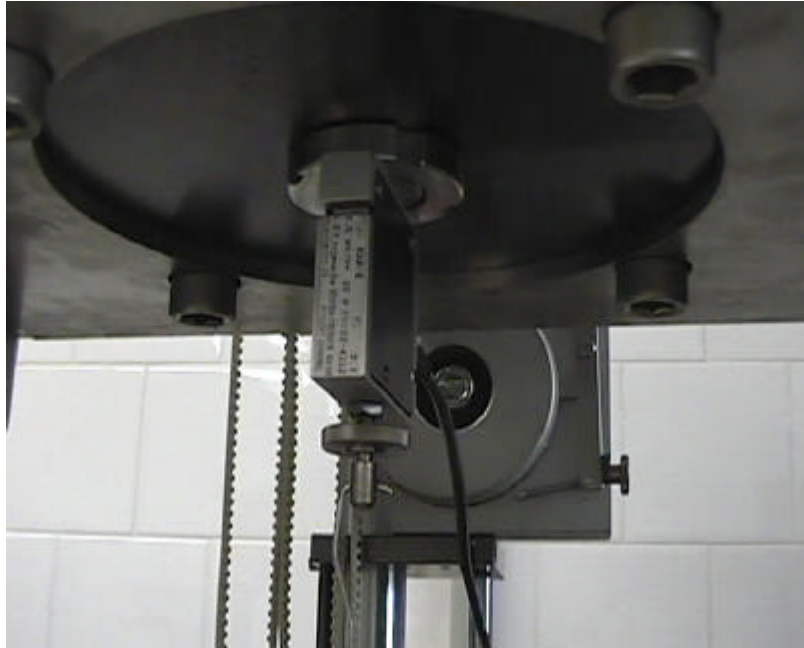
Figura 5.13: Detalle de la célula de carga y su disposición. Se puede apreciar el extremo curvado de la varilla de 660 mm que transmitirá la fuerza a la probeta.
