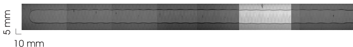
Figura 1.7: Exemple d'un dit generat en els experiments amb un forçament periòdic. La freqüència de forçat era 0.22 Hz i V_\infty = 1.42 mm/s. La regió brillant correspon a la zona que es va analitzar.
