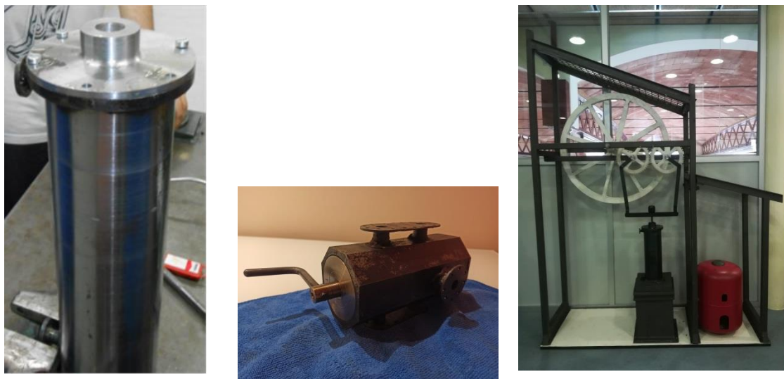
Figures 8,9 i 10: Resultat de les maquetes en ordre d'esquerra a dreta: cilindre, registre i engranatges acoblats al pistó del cilindre.
