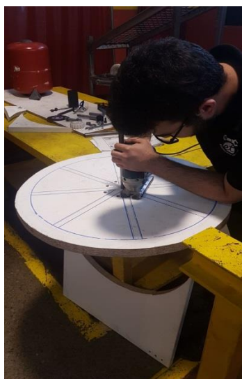
FIGURA 7. Mecanització del volant d'inèrcia amb caladora
