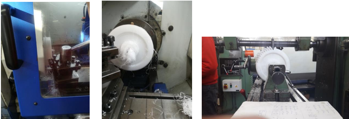
FIGURES 4, 5 I 6. En ordre de dreta a esquerra, reducció de diàmetre utilitzant el torn universal, buidatge de les corones i mecanització de les dents de les corones amb fresa de mòdul 4
