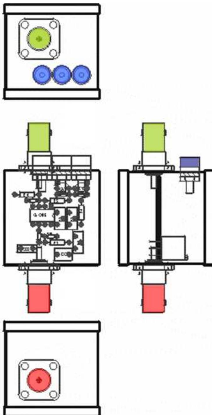
**Figura H.2** Vistas del montaje del amplificador ajustable del procesador de señal
