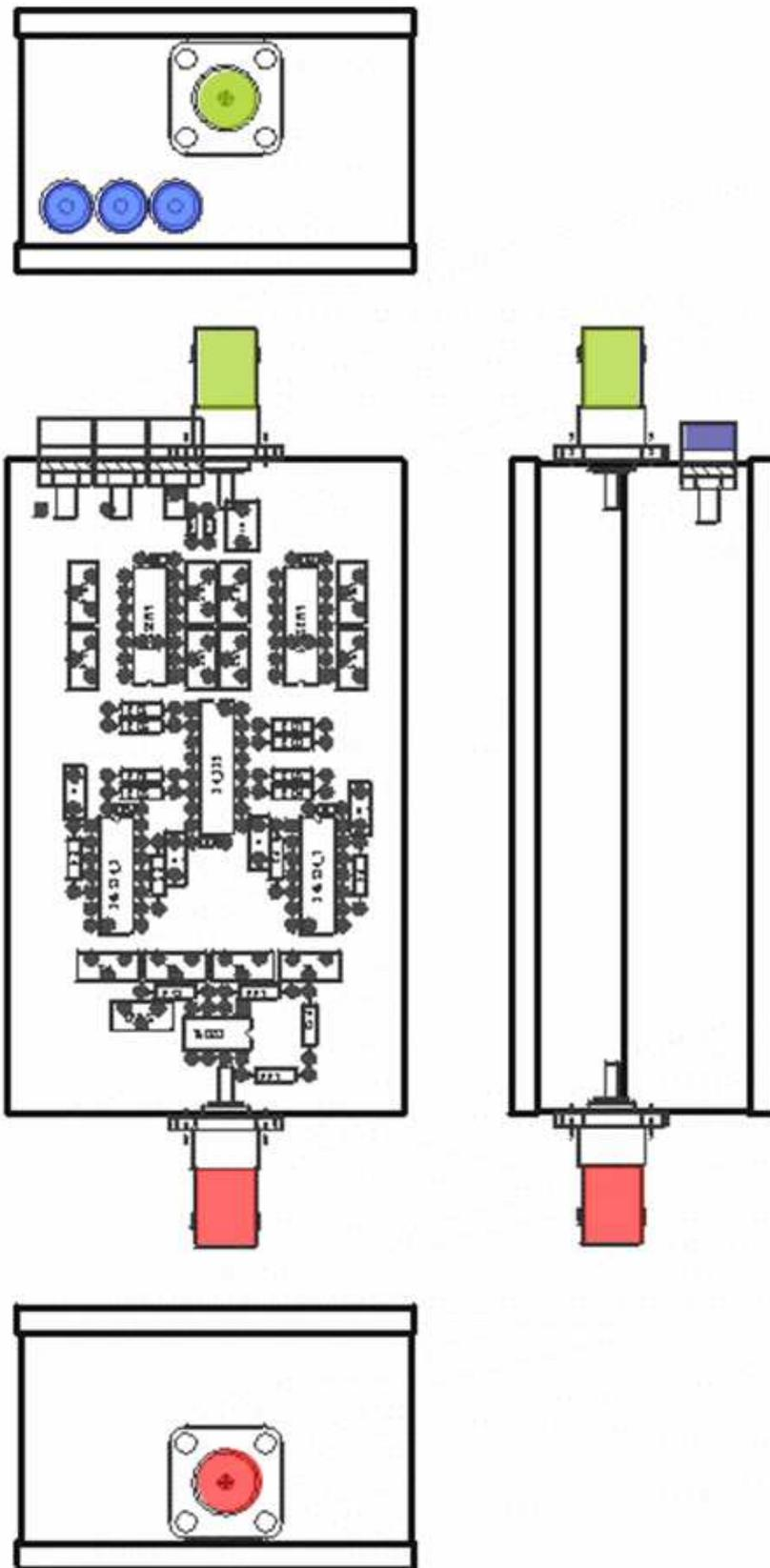
Figura H.3 Vistas del montaje del procesador de pedestal
