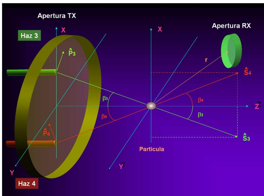
Figura C.1 Geometría Sistema LDA con haces en el eje  $X$
