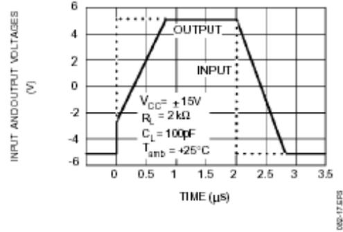
OUTPUT VOLTAGE VERSUS ELAPSED TIME
