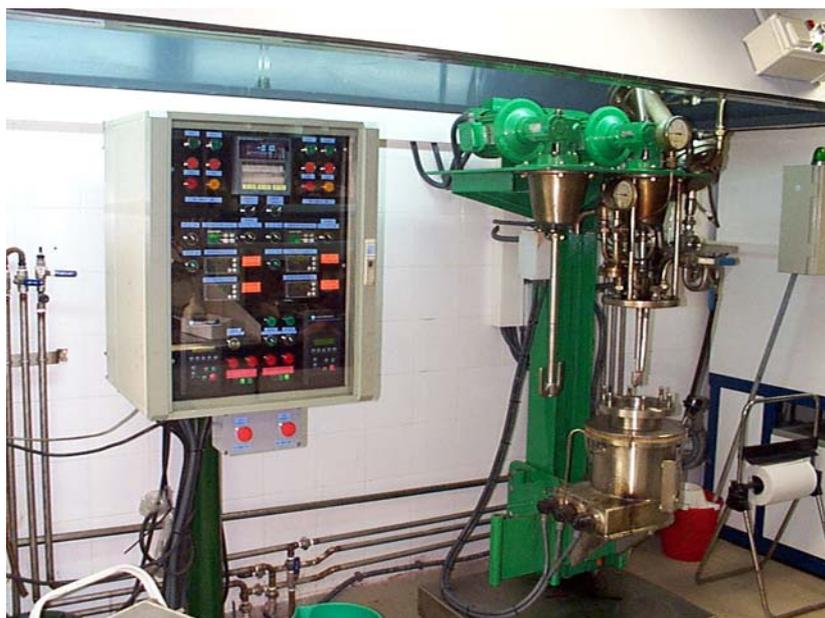
Figura 3.4. Reactor BACHILLER de 5 litros de capacidad utilizado en los ensayos a escala de kilogramos.
