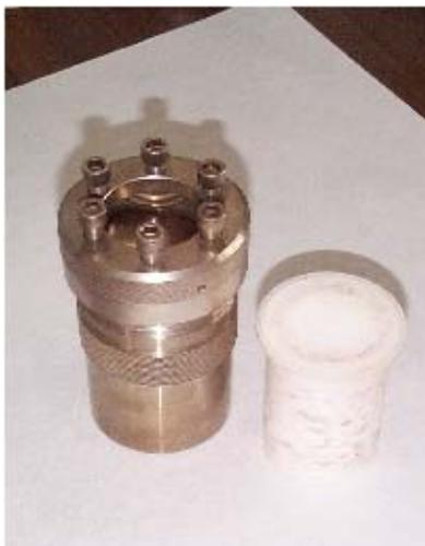
**Figura 3.3. Bomba Parr 4748, de 125 ml de capacidad utilizada en los experimentos a escala de laboratorio de síntesis de zeolitas.**
