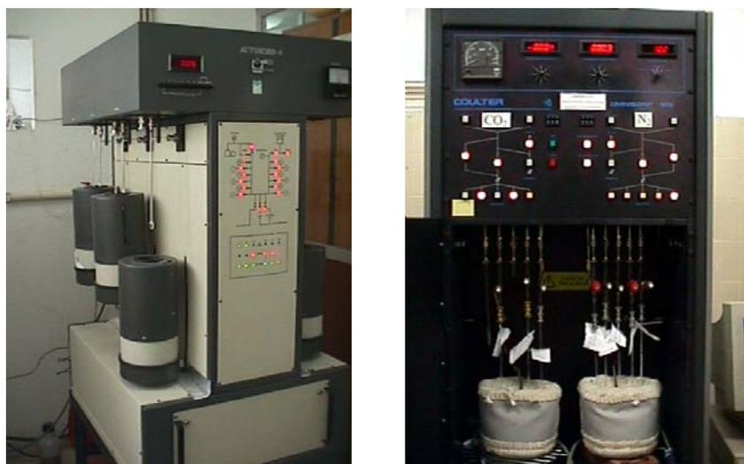
Figura 3.6. Equipos de los laboratorios de la Universidad de Alicante utilizados para la caracterización de la textura porosa de las zeolitas. La imagen de la izquierda muestra el equipo desgasificador AUTOSORB DESGASER-6 utilizado para la caracterización con  $N_2$  y la imagen de la derecha muestra el equipo OMNISORB 610 utilizado para la caracterización mediante  $CO_2$ .
