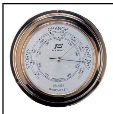
Figura 12: Detalle de un barómetro aneroide.
