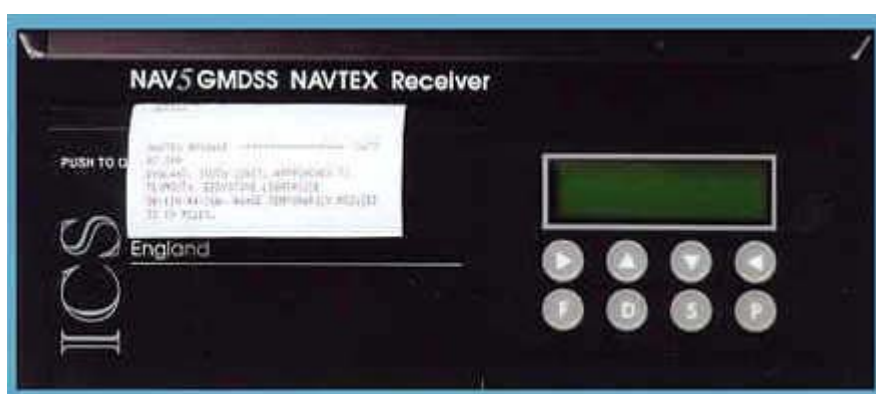
Figura 4: Vista frontal de un receptor Navtex.
