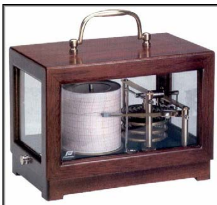
Figura 13: Fotografía de un barógrafo de cápsulas de Vidi.
