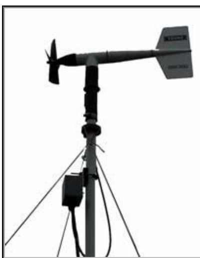
Figura 15: Detalle de un anemómetro de eje horizontal.
