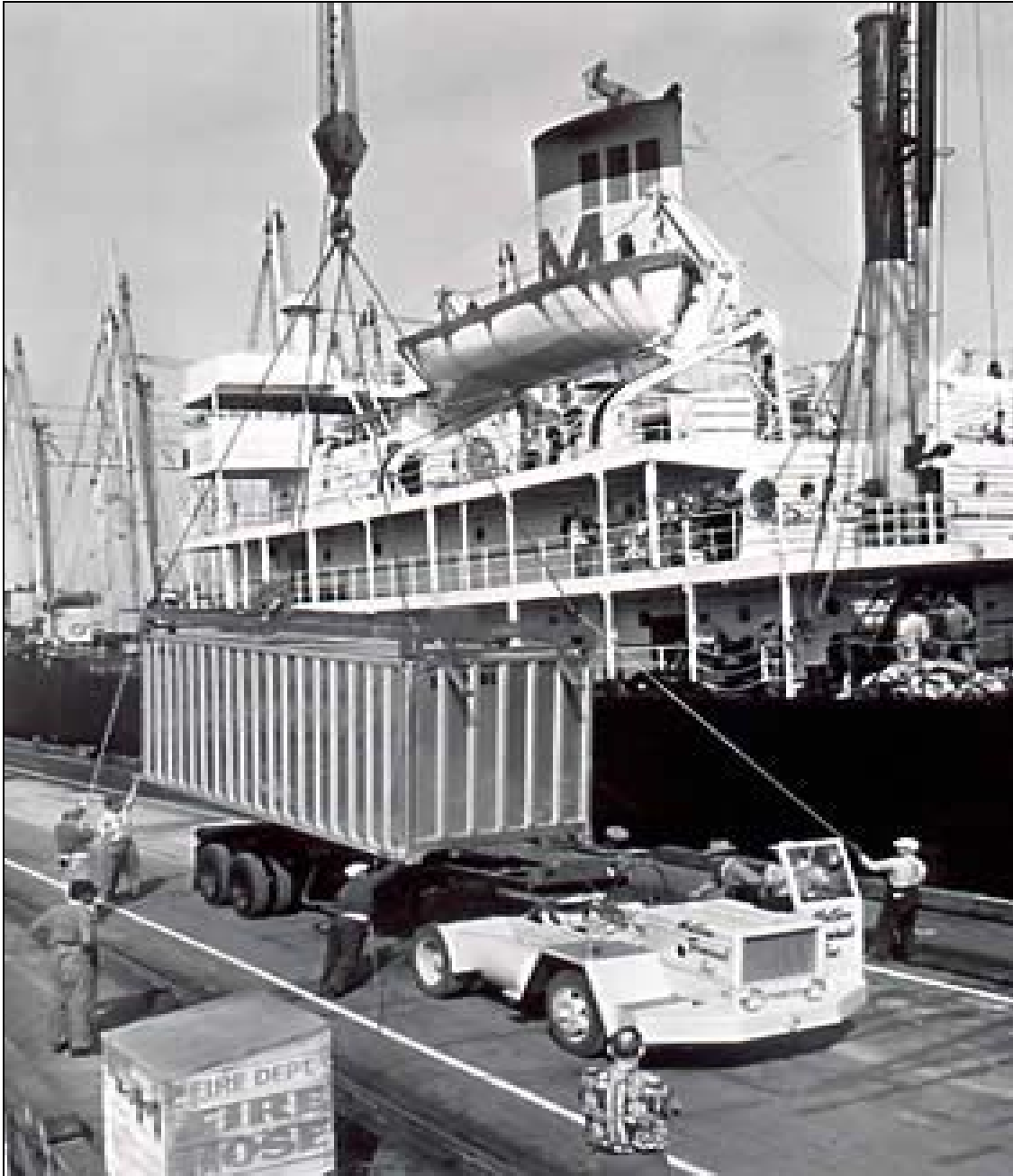
Foto 2 Descarga de contenedores con puntales y spreader semiautomático 7
