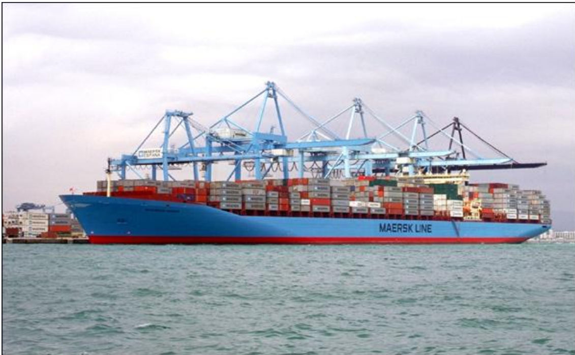
Foto 13 Operativa del buque Sovereign Maersk de 6600 TEUS, trabajando con 4 grúas Post-Panamax y una Panamax 29
