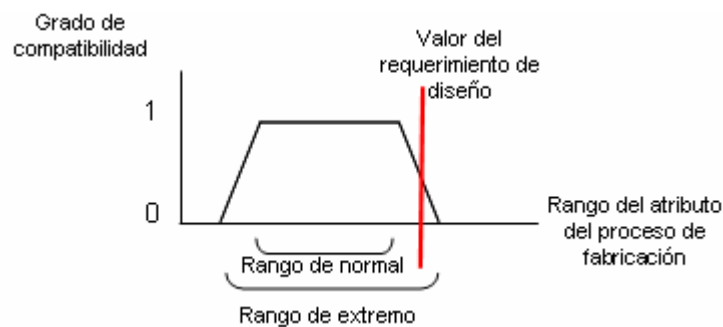
Figura 2-18: Representación de la compatibilidad entre un atributo de proceso y un requerimiento de diseño, según (Giachetti, 1997)
