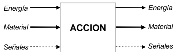
Figura 3-4: Representación de la función en un sistema técnico (Pahl et al., 1996).
