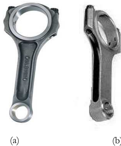
Figura 4-9: Tipos de bielas en función de la forma del cuerpo: a) Tipo I convencional y b) Tipo H
