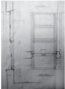
1153. Un dels primers dibuixos de la finestra en guillotina patentada per Hakh i Forteza l'any 1939. ASAL
