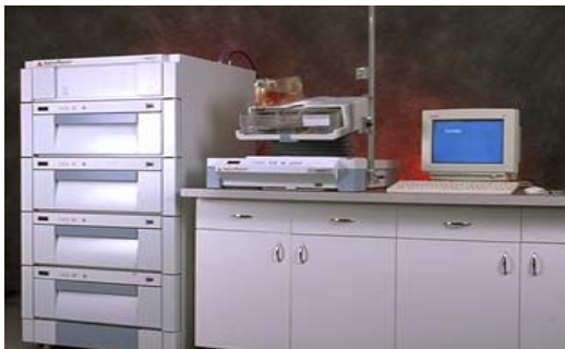
Fig. 5.10.: Bioreactor de Aastrom y el casete desechable en donde se realizará el cultivo y la expansión celular. (Imagen cedida por Aastrom Biosciences Inc).
