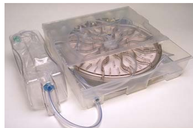
Fig. 5.10.: Bioreactor de Aastrom y el casete desechable en donde se realizará el cultivo y la expansión celular. (Imagen cedida por Aastrom Biosciences Inc).
