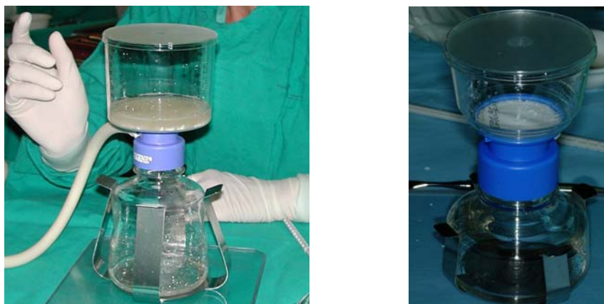
Fig.5.11.: Dispositivo de filtración a bajo flujo. En la parte superior de la campana se retiene y se mezcla la matriz con las MSCs.
