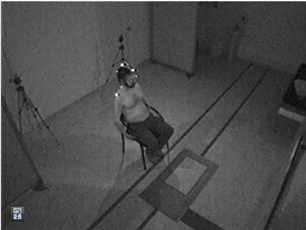
Figura 6. Imagen captada por las cámaras, en donde se observan los marcadores para determinar los ángulos de movimiento de la columna cervical mediante el estudio del movimiento en 3D.
