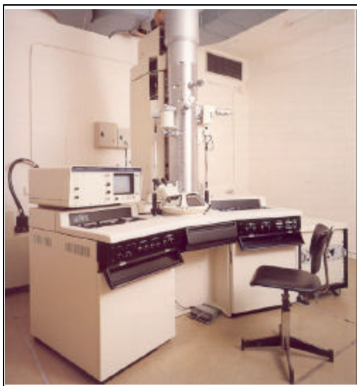
Fig. 2. Microscopi electrònic de transmissió Hitachi H600-AB dels Serveis Científico-Tècnics de la Universitat de Barcelona.
