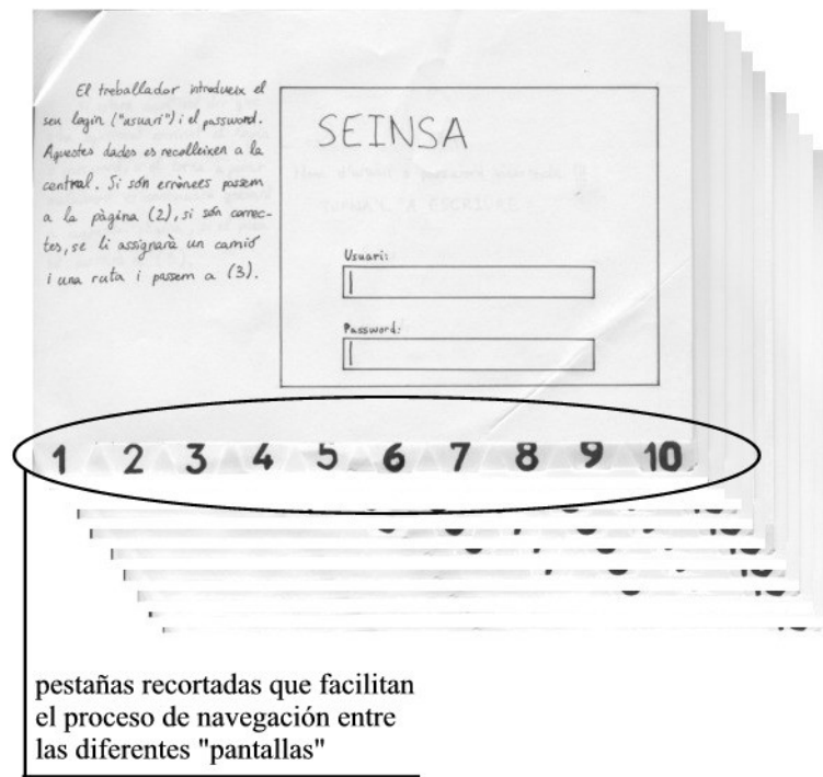
Figura c5_7a: Una de las maneras de presentar un prototipo de papel para que pueda ser utilizado por un usuario es mostrándolo en formato de pestañas como las que muestra la imagen. Esta técnica proporciona ciertas posibilidades interactivas al prototipo que facilitan su evaluación. Este ejemplo concreto corresponde al proyecto Seinsa relativo a la recogida selectiva de basura
