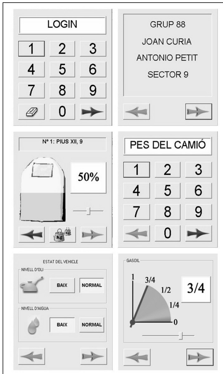
Figura c5_22a: Pantallas correspondientes al prototipo software desarrollado para el proyecto Seinsa. Se trata de un prototipo horizontal realizado utilizando el lenguaje de programación Java
