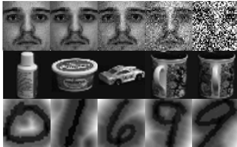
Figura 6.2: Bases de datos utilizadas en la validación del método RKDCV, para el caso del tamaño de muestras pequeño. Fila 1, ejemplo de la degradación de las imágenes con ruido gaussiano de 0, 0.02, 0.04, 0.06 y 0.08, en la base de rostros AR NG. Filas 2 y 3, algunas imágenes de las base de datos Coil-40/30 y Mnist, respectivamente.
