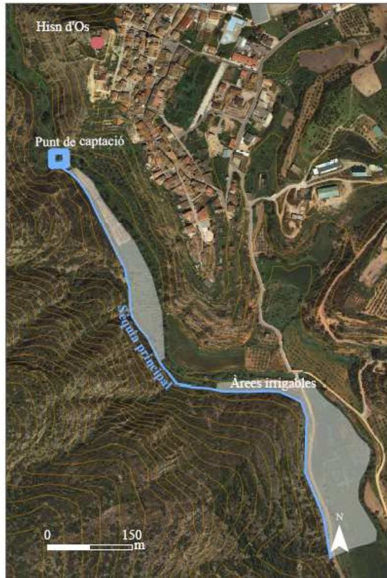
Fig. 3.4.4 Sistema hidràulic andalús d'Os associat al riu Farfanya. Font ICC, elaboració pròpia.
