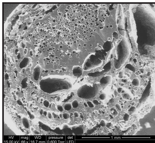
Figura 5.23. Sección transversal de Rhododendron sp. con fisuras producidas durante la combustión
