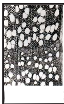
Figura 4.33. Tensión de una angiosperma (Schweingruber, 1996: 88)
