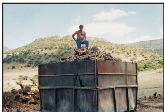
Figura 6.31. Caja metálica donde se cuece leña de menor calidad y se obtiene carbón de menor calidad.
