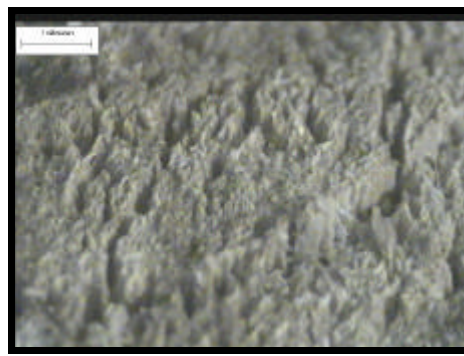
Figura 5.30. Levantamiento de la superficie de la estructura debido al arrastre de la hoja sobre la misma.
