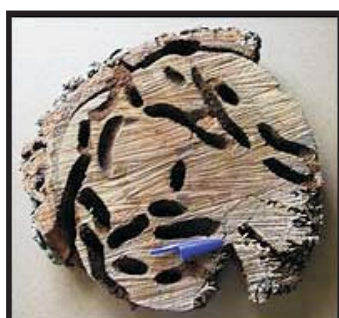
Figura 4.38. Acción de los xilófagos sobre la madera
