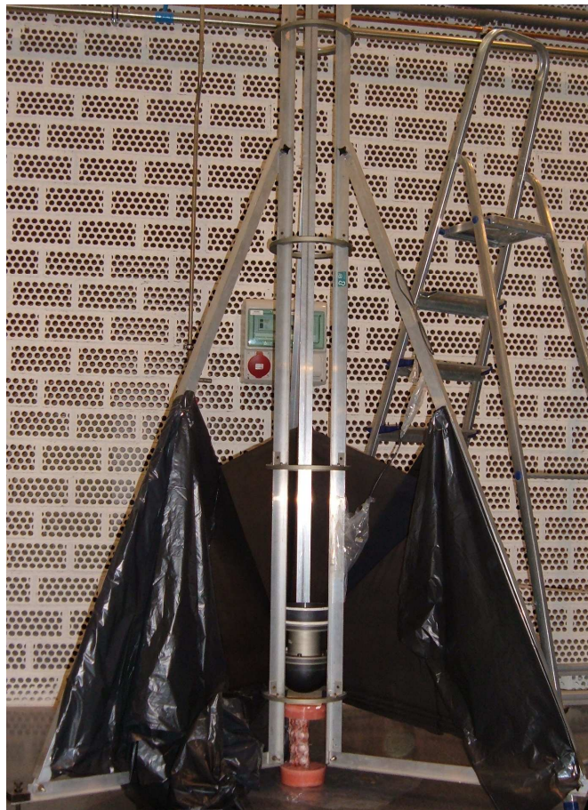
Figura 34. Instalación para la generación de la fractura
