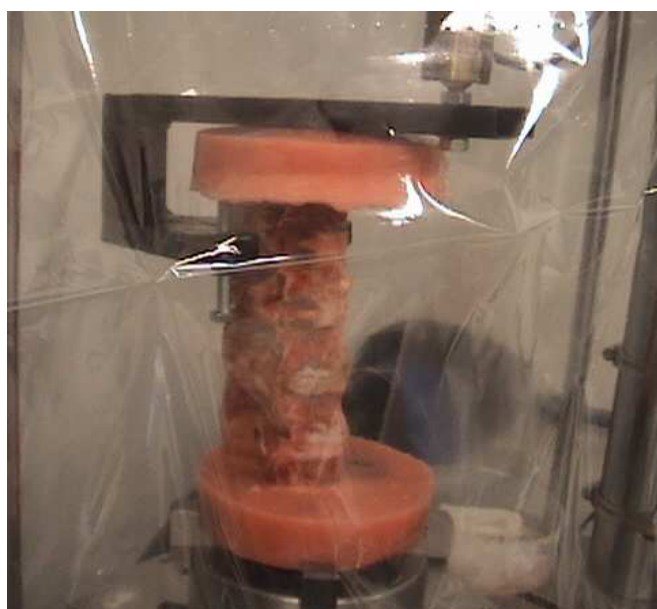
Figura 32. Montaje del ensayo de flexo-compresión
