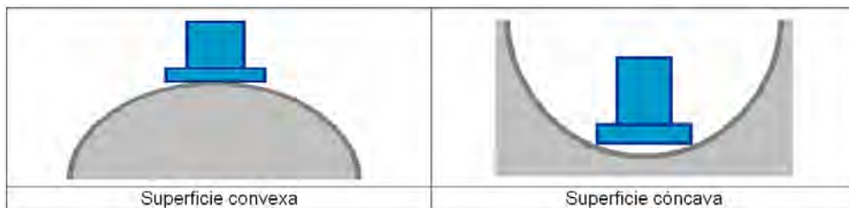
Figura 2.25: Efecto de la curvatura superficial.
