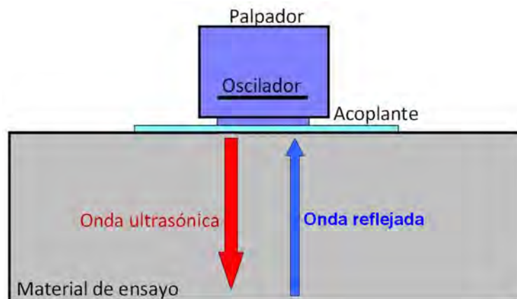
Figura 2.23: Método de contacto con incidencia normal..
