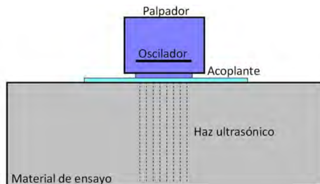
Figura 3.17: Técnica de incidencia normal por contacto directo
