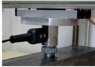
Figura 3.19: Sensor posicionado en el sistema automatizado de captura
