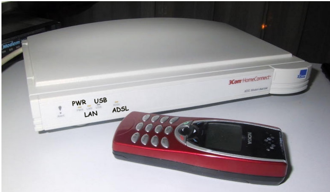
Módem ADSL, visión frontal. Modelo HomeConnect DualLink Fabricante: 3Com
