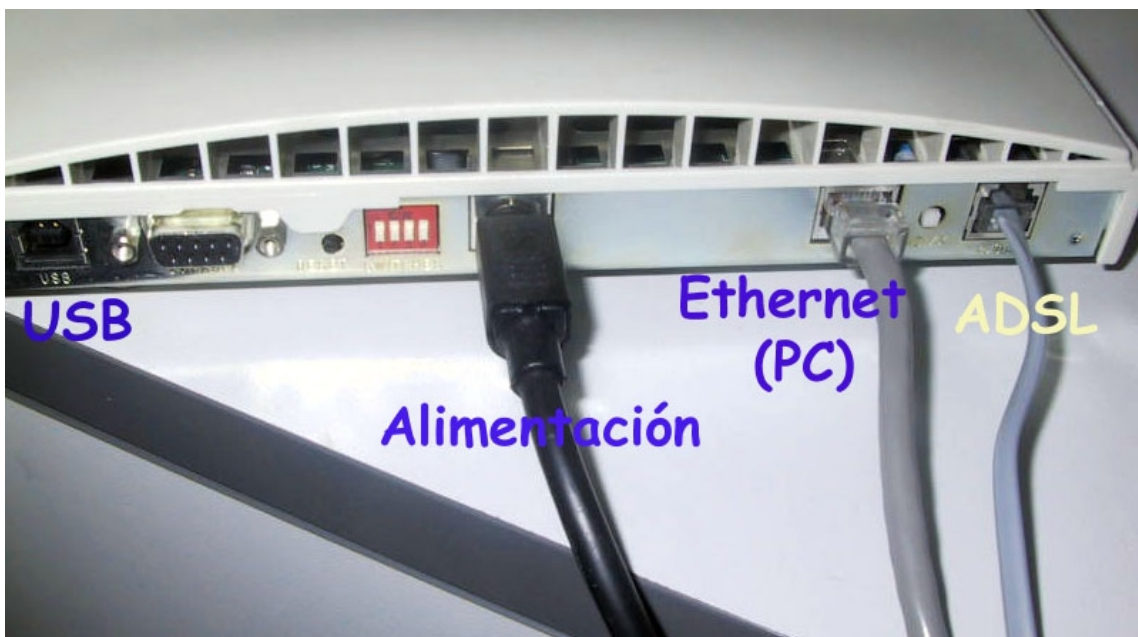
Vista Trasera del mismo módem, en donde se indica la función de cada cable.
