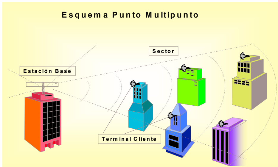
Esquema general de un sistema LMDS: Punto Multipunto
