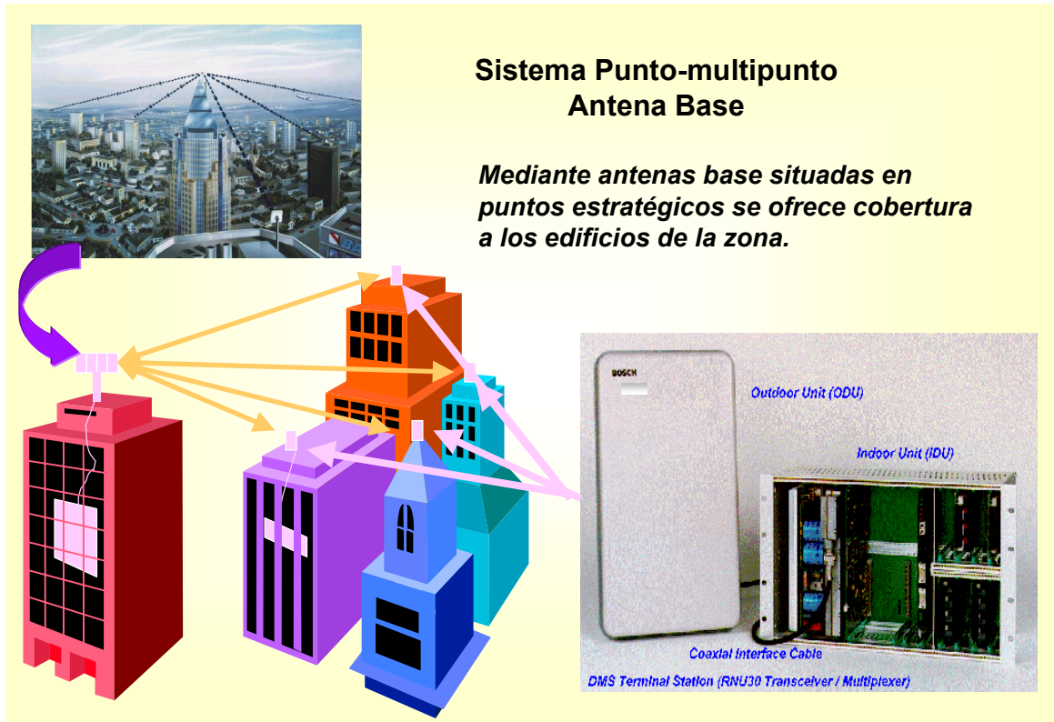
Sistema Radio de Distribución Punto a multipunto. Fotografía Estaciones Base: Fuente Retevisión.
