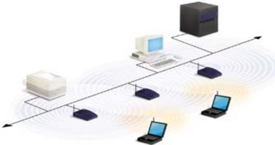
Elementos de la red: Tres puntos de acceso que generan los frentes de ondas (en azul), un par de portátiles con el adaptador WLAN (pequeña antena), un servidor, un PC fijo y una impresora.
