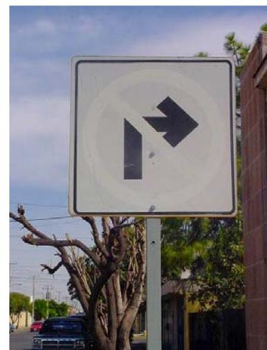
Fig. 4.5. Señal afectada por la luz solar. El anillo y la raya roja de esta señal, han sido quemadas y borradas por la intensa iluminación solar, en una calle de San Luis Potosí.
