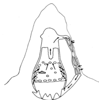
Fig. 8.79. Montículo de Macrotermes . El aire que ingresa al termitero, a través de los poros de las paredes, es enfriado en el sótano y sube fresco por todos los conductos, saliendo el aire caliente por los extremos superiores. Ilustración: Turid Hölldobler-Forsyth.
